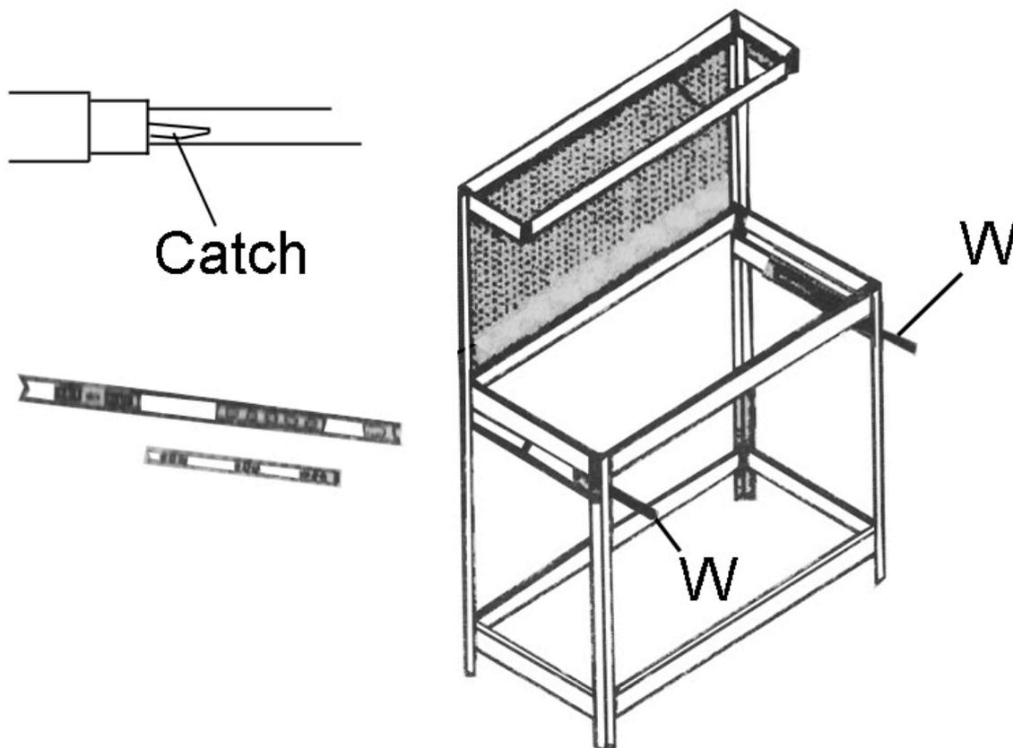
5) Separare il componente più sottile della guida dalla barra intermedia, usando il gancio a molla (appena visibile nel punto in cui le due parti si incontrano) e sfilandolo dalla parte che rimane avvitata alle gambe del banco.
