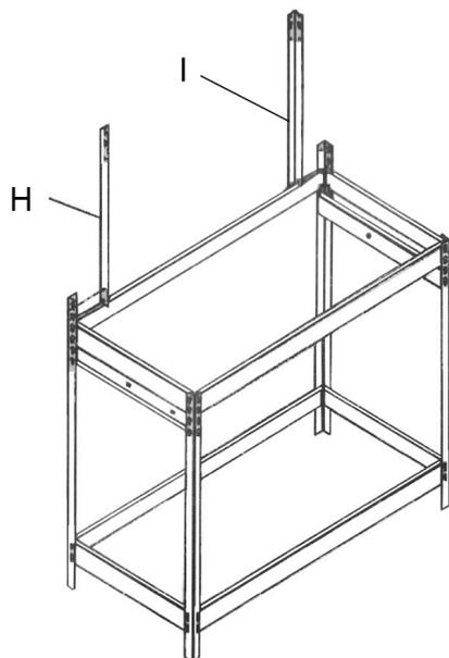
6) Montare la Traversa superiore (J) ai Montanti pannello sinistro e destro (H e I). Usare i bulloni, dadi e rondelle forniti.
