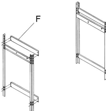
4) Montare le 4 Traversate lunghe (G) alle estremità delle gambe, per creare la struttura. Usare i bulloni, dadi e rondelle forniti.
